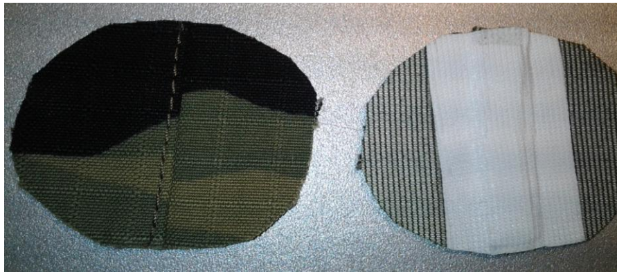
А Б Фиг.2 Проби подлепен шев; А- лицева страна; Б- вътрешна, подлепена
